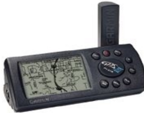
Abbildung 4: Garmin GPS III (Größe: 12,7 x 5,9 x 4,1 cm; Gewicht: 255 g mit Batterie)
