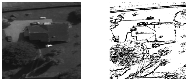
Abb. 7: Bildsegmentierung eines schwarz-weiß Luftbildes durch multifraktale Analyse in Fraclab
