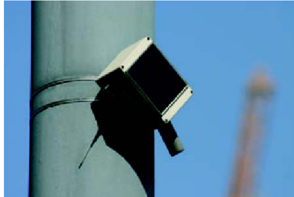
Abbildung 11: Verkehrssensor von traffic.at [Foto: www.traffic.at]
