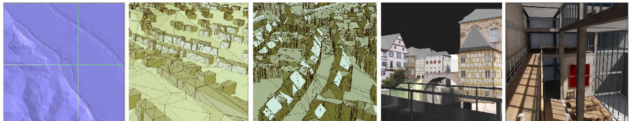
Abbildung 3: Detaillierungsstufen / Level-of-Detail 0 bis 4 [eigene Darstellung]
