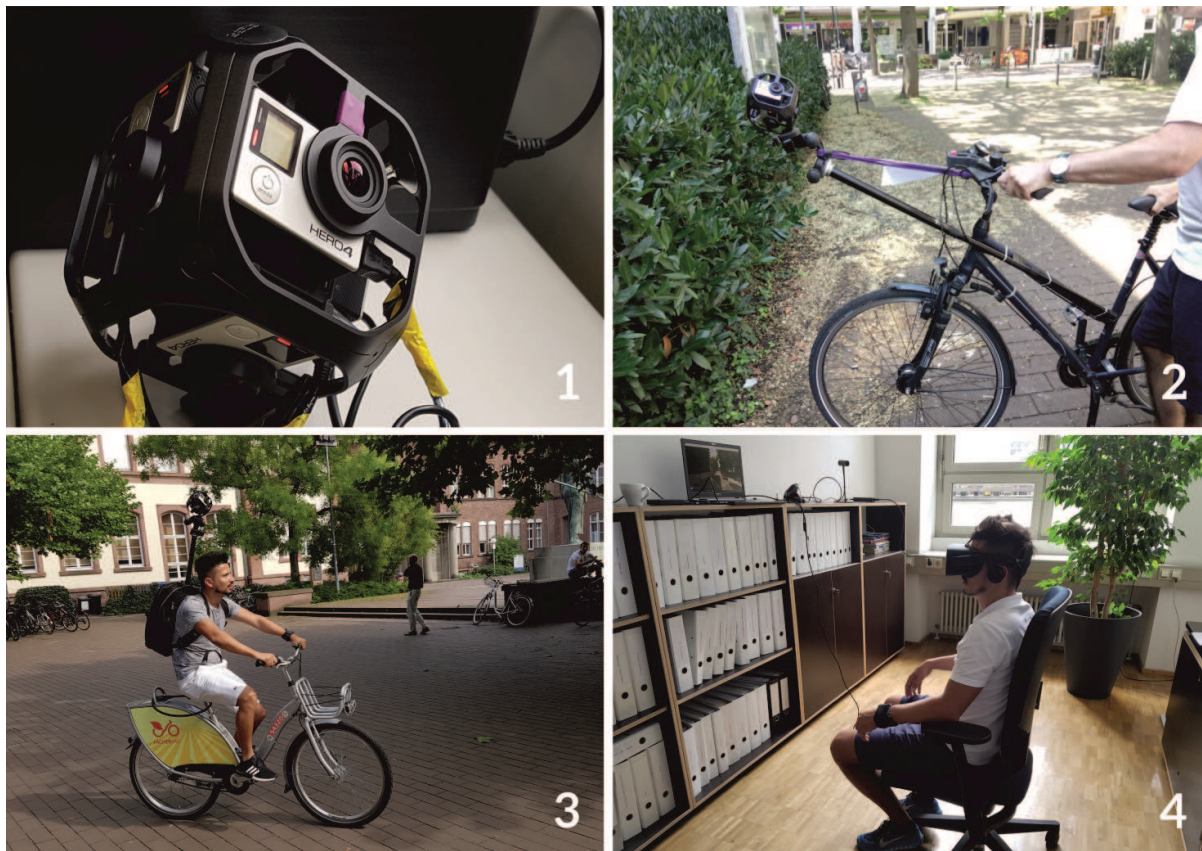
Abb. 1: Das Omni-Rig (1) mit seinen sechs synchronisierten Action-Cams zur Erstellung von sphärischen Videos. Testfahrten im sogenannten „Auslegermodus“ (2) und im „Streetview-Modus“ (3). Das zusammengesetzte Video kann nun auf der Oculus betrachtet werden (4) und als audiovisuelle Testumgebung für das biostatistische Monitoring eingesetzt werden.
